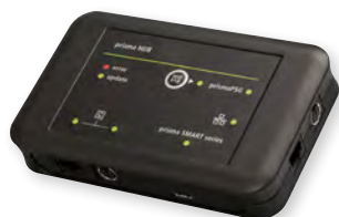
prisma HUB Module de connexion prisma SMART / SOFT WM 31660
